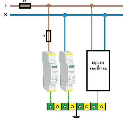
MODO COMÚN: Conexión V-SHAPE (en Serie)
